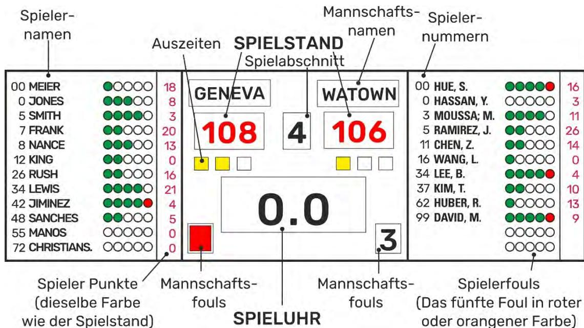
**Bild 9 Anzeigetafel für Wettbewerbe der Stufe 1 (Ausführungsbeispiel)**
