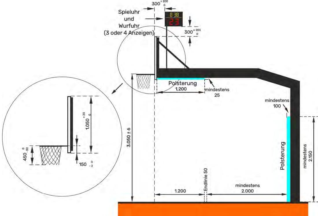
Bild 16 Korbanlage Stufe 1 (Wurfuhr Option 1)
