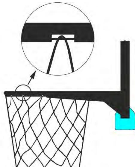
**Bild 5 Netzbefestigung
